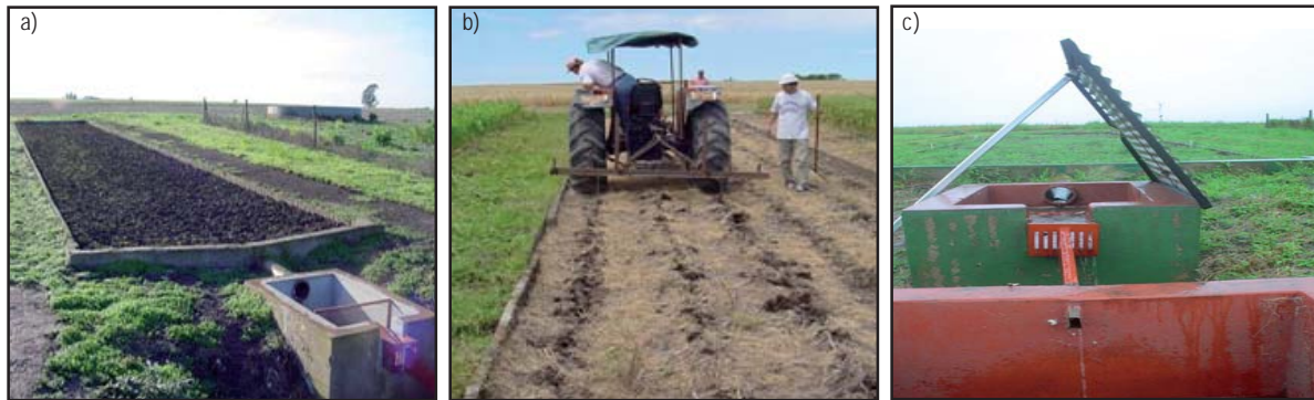
Figura 2. Parcelas de escorrentías ubicadas en INTA EEA Paraná. a) parcela de suelo laboreado y sin cobertura. b) paso de cincel para preparar la siembra de maíz continuo. c) pileta de la parcela de soja continua recolectando agua de escurrimiento.
